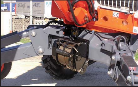
ARGANO SU TELAIO WINCH ON THE CHASSIS TREUIL SUR LE CHASSIS WINDE AUF DEM CHASSIS
