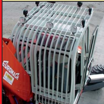
PROTEZIONE CABINA PROTECTION OF THE CABIN PROTECTION DE LA CABINE SCHUTZGITTER DER KABINE
